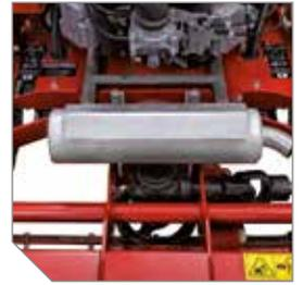
Robusto albero di trasmissione con scatola di rinvio e giunto cardanico tra motore e rotore.
