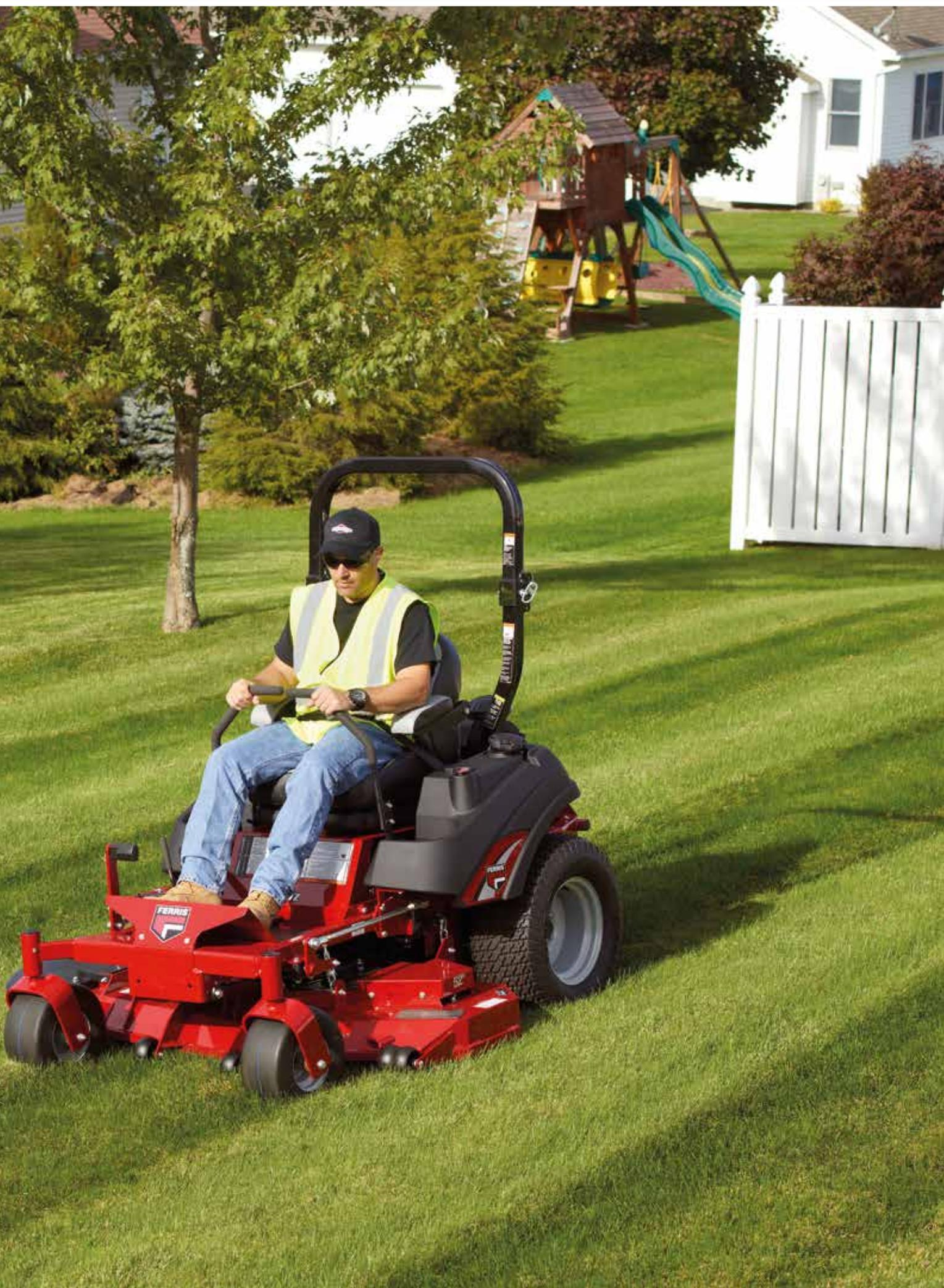
Progettata per affrontare anche le condizioni più impegnative, la Ferris® F210Z è all'altezza della sfida. Dotata di componenti di alto livello, come le trasmissioni integrate professionali Hydro-Gear® ZT-5400 Powertrain® e portalama in ghisa con ingrassatori accessibili dall'alto, è una macchina da lavoro sulla quale voi e la vostra squadra potete contare.
