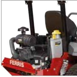
Il motore Vanguard™ BIG BLOCK™ 993 cc EFI con Oil Guard System fornisce una grande potenza e bassi consumi, riducendo la manutenzione ed i costi.
