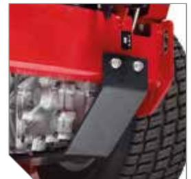
I ripari per le trasmissioni sono sagomati in modo da ridurre l'accumulo di detriti, migliorare il flusso d'aria e permettere l'accesso al filtro dell'olio per la manutenzione.
