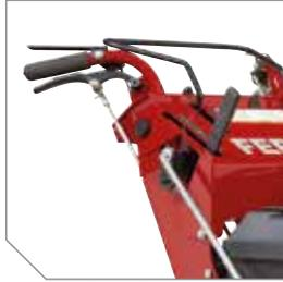
La leva del freno di stazionamento è in posizione comoda a fianco del cruscotto, per un facile e veloce azionamento da parte dell'operatore.
