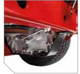
I ripari per la trasmissione sono sagomati in modo da ridurre l'accumulo di detriti, migliorare il flusso d'aria e permettere l'accesso al filtro dell'olio per la manutenzione.
