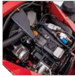
L'efficiente motore diesel 3 cilindri Yanmar (modello 3TNM74F-SAFS) rispetta le normative sulle emissioni EPA Final TIER 4 (Euro 5).
