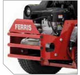
Il robusto paraurti protegge il motore permettendo anche un facile accesso per la manutenzione.
