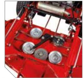
Il sistema di trasmissione del piatto rasaerba consente una tensione ottimale della cinghia, per una maggiore durata e ridotta manutenzione.
