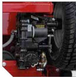
Trasmissioni idrostatiche integrate professionali Hydro-Gear® ZT-3400, progettate per alte prestazioni e grande resistenza.
