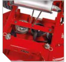
Il sistema di tensionamento, le puleghe con diametro maggiorato e gli appositi ripari prolungano la durata delle cinghie e riducono l'usura dei cuscinetti.
