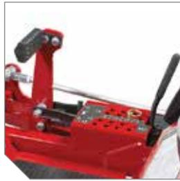
Il sistema di sollevamento piatto rasaerba azionato a pedale, regolabile, riduce lo sforzo necessario per regolare l'altezza di taglio.
