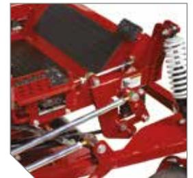
Il sistema di sollevamento piatto rasaerba idraulico, azionato a pedale, permette di alzare o abbassare il piatto senza sforzo.
