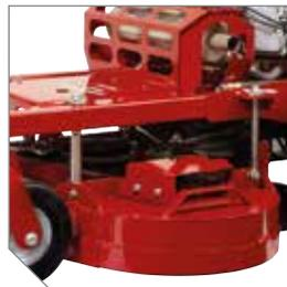
Il sistema di sostegno del piatto rasaerba è realizzato con un numero inferiore di componenti ed è dotato di punti di ingrassaggio per una maggiore durata ed una manutenzione ridotta.
