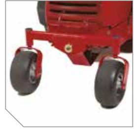
Il ponte posteriore oscillante unito al telaio anteriore mobile permettono alla F800X di seguire il profilo del terreno ed ottenere una finitura perfetta.
