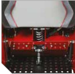
Il sistema brevettato di piattaforma ammortizzata è regolabile per una ampia gamma di pesi e condizioni di lavoro, ottimizzando il comfort dell'operatore ed aumentando la produttività.
