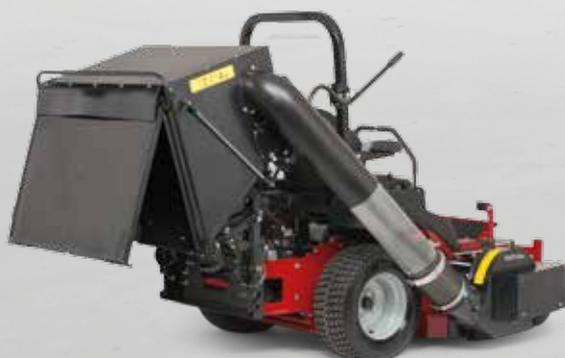
La zero turn F210Z può essere dotata di un sistema di raccolta opzionale da 396 litri. Una leva in posizione ergonomica aumenta la produttività dando all'operatore la possibilità di svuotare l'erba tagliata direttamente dal sedile di guida.
