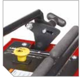
Il comando velocità di avanzamento è in posizione comoda ed è dotato di un blocco rapido a 3 posizioni.
