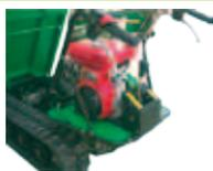
potenti ed affidabili a valvole in testa, silenziosi, ecologici e facili da avviare. Gli ampi parafranghi ai lati del motore riparano i comandi dal fango sollevato dai cingoli. La potenza elevata e la rapidità di risposta garantiscono velocità di trasferimento elevate.
