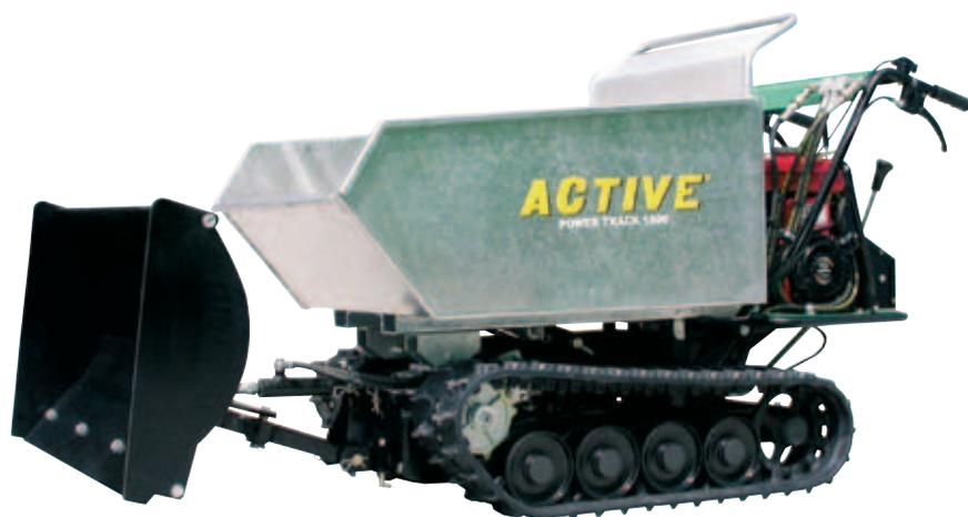
Attrezzo di facile operatività, permette la pulizia della stalla, l'ammasso di materiale sfuso e lo sgombero della neve o di materiale inerte. Il Kit è composto da una robusta pala in acciaio che può essere regolata sia in senso verticale, sia lateralmente.
