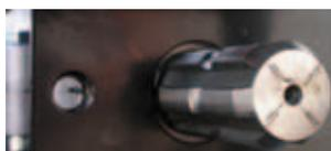
Il modello 1460 può essere dotato di PRESA DI FORZA con albero di  $\varnothing 1\ 3/8''$  a 6 scanalature per l'applicazione di attrezzi speciali. Il regime di rotazione massimo è di 800giri/min.
