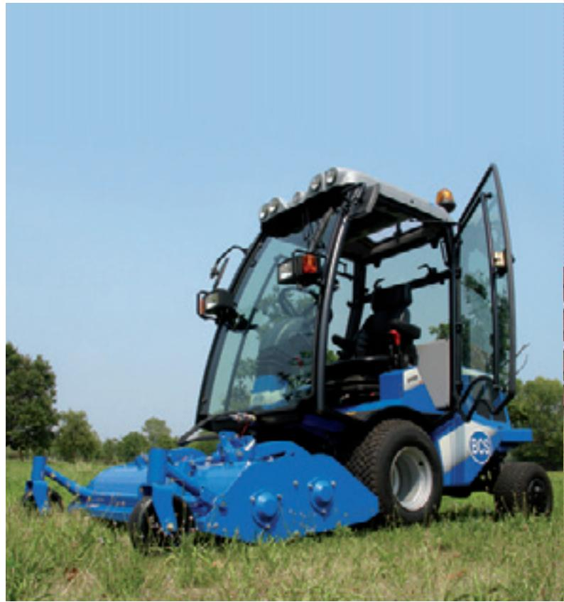
La **Ma.Tra 300** porta aria nuova, anzi “un taglio nuovo” nella categoria delle macchine da manutenzione. In effetti questa macchina polivalente, oltre ad essere impiegata come tosaerba è in grado di assolvere molte delle operazioni di manutenzione urbana o, in generale, di aree adibite a verde. Basta infatti sostituire l’attrezzo per renderla versatile a molteplici lavori.
