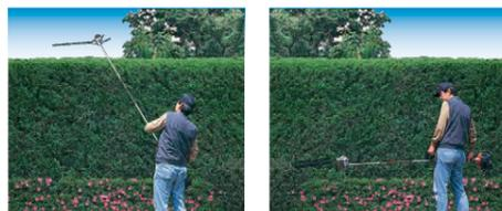
Questo tosasiepi è l'ideale per il professionista. Grazie alla sua particolare conformazione, risulta molto comodo da utilizzare. Il motore resta sempre lontano dal viso cosicché i gas di scarico si disperdono senza nuocere all'operatore.
