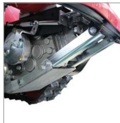
Una slitta posteriore protegge il cambio da eventuali urti. È costituita da tre elementi con spessore di 2 mm e protezioni angolari.
