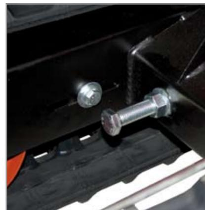
I tendicingoli, posizionati anteriormente nella parte interna del telaio, sono facilmente azionabili (solo due registri).
