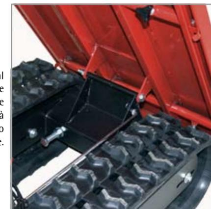
L'attacco del pianale al telaio è estremamente robusto e garantisce sicurezza ed affidabilità nel trasporto e nello scarico del materiale.
