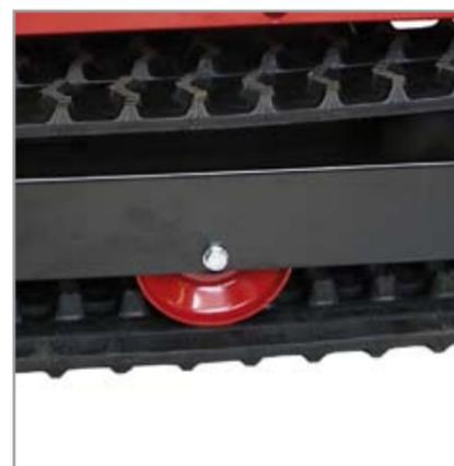
Il telaio è stato progettato per proteggere i rulli dal fango. I cingoli ad alta resistenza sono rinforzati all'interno con 20 corde d'acciaio e permettono l'impiego su qualsiasi percorso.
