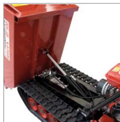
Il ribaltamento del cassone avviene tramite un pistone idraulico.
