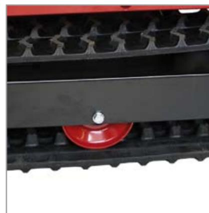
Il telaio è stato progettato per proteggere i rulli dal fango. I cingoli ad alta resistenza sono rinforzati all'interno con 20 corde d'acciaio e permettono l'impiego su qualsiasi percorso.
