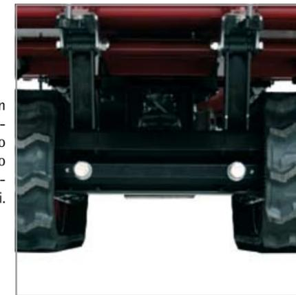
L'altezza da terra di ben 10 cm e il profilo inferiore estremamente pulito facilitano il movimento anche su terreni particolarmente sconnessi.
