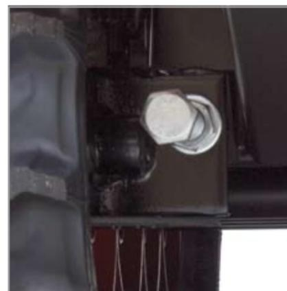
I tendicingoli, posizionati posteriormente nella parte esterna del telaio, sono facilmente azionabili (solo due registri).
