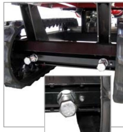
I tendicingoli, posizionati anteriormente nella parte esterna del telaio, sono facilmente azionabili (solo due registri). Sono dotati di ingrassatore. I cingoli ad alta resistenza sono rinforzati all'interno con 20 corde d'acciaio e permettono l'impiego su qualsiasi percorso.
