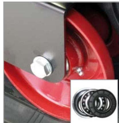
Gli ingrassatori sui rulli sono un dettaglio che testimonia la cura costruttiva che Ibea impiega in tutti i Minitransporter. I rulli infatti sono montati su doppi cuscinetti di grandi dimensioni, protetti da paraoli e dotati di ingrassatori per permettere la corretta manutenzione e garantire la massima durata.
