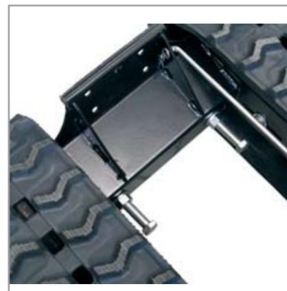
I tendicingoli posizionati anteriormente nella parte interna del telaio, sono facilmente azionabili (solo due registri).
