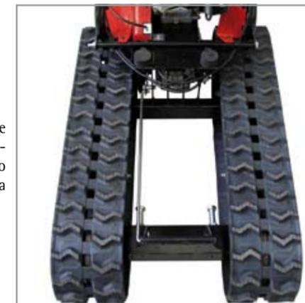
Il telaio è robusto e sgombro da componenti; nulla ostruisce lungo la marcia
